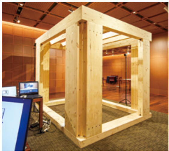
「木質耐震シェルター 70K」 70kN（7トン）までの荷重に耐えられる。商品名「70K」はこの70kNからきている。落下物を押さえる天井根太のせいを大きく、ピッチを短くし、ルーバーのような意匠を実現
